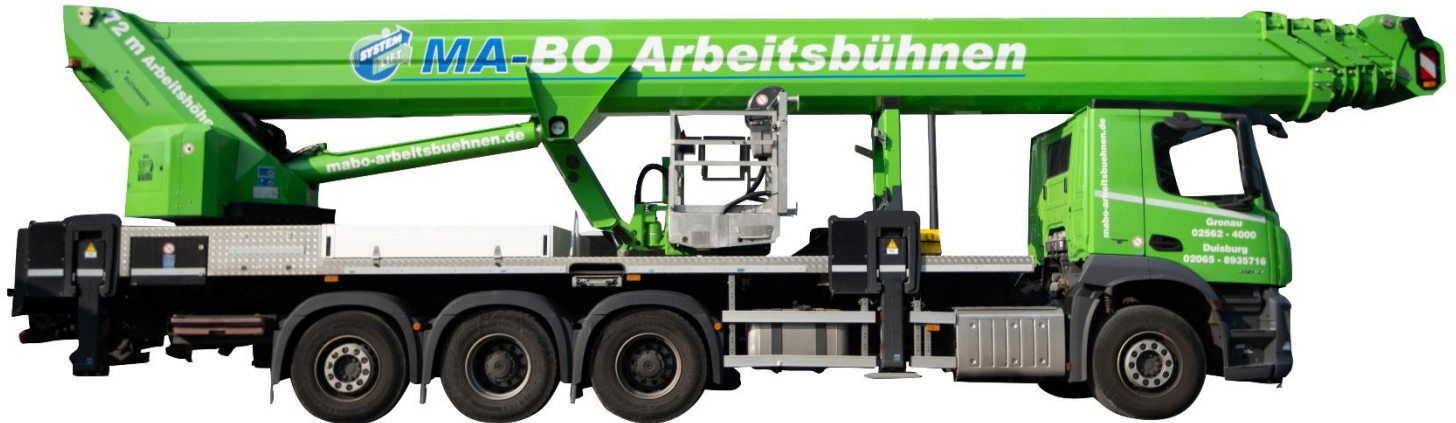
72m LKW-Arbeitsbühne (Führerschein C) Ruthmann Type: T720
